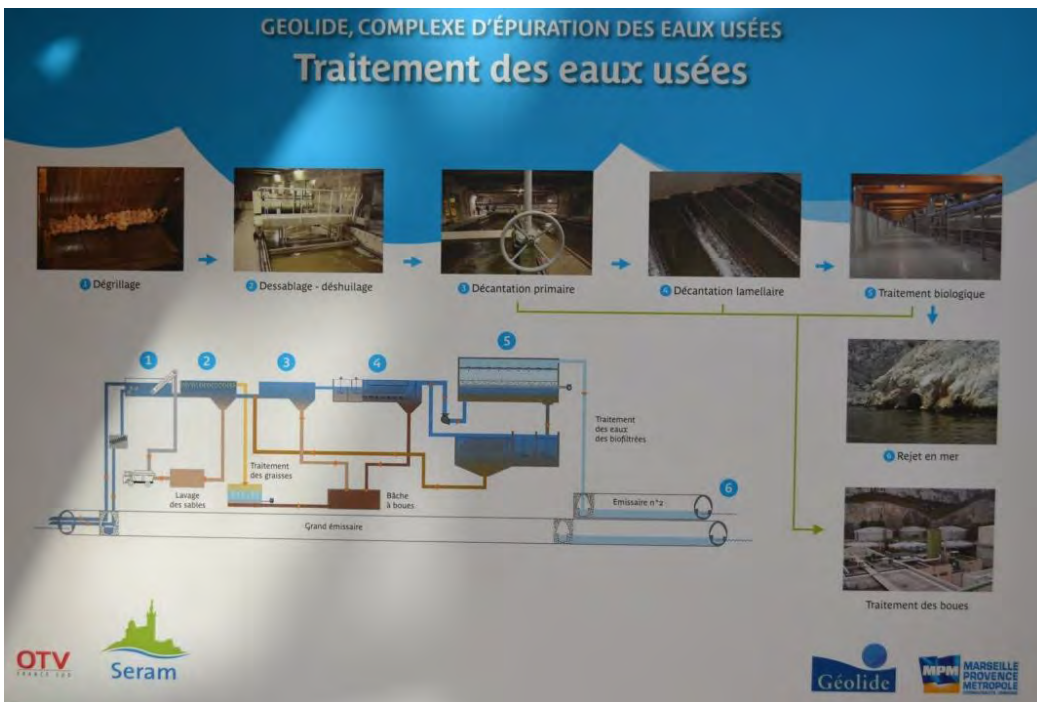
Abbildung 4.4: Schritte der Aufbereitung Quelle: Thiemann 2013
